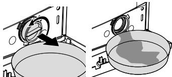
Поставьте перед фильтром вместительную емкость для слива воды. Понемногу поворачивайте фильтр насоса против часовой стрелки, пока не начнет выливаться вода. Слейте воду в установленную перед фильтром емкость. Всегда держите под рукой тряпку для сбора пролитой воды. Когда вода перестанет вытекать, полностью выверните фильтр и выньте его из машины. Очистите внутреннюю часть фильтра и пространство вокруг крыльчатки насоса от мусора и волокон. Вставьте фильтр на место.
